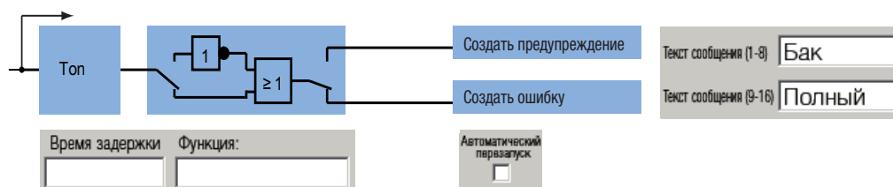
▲ Функциональность шести цифровых входов 1DI0–2DI5 модулей DX111 и DX122.
